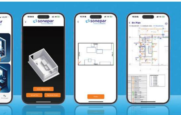
Mit der neuen Sonepar-Digiplan-App lässt sich via LiDAR-Grundrißerfassung\* mit dem iPhone Pro oder iPad Pro in wenigen Augenblicken ein kompletter Raum scannen und automatisch ein detaillierter Grundriß erstellen.
