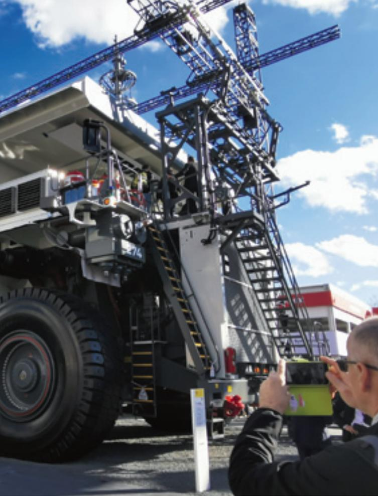
*Hingucker vor dem Liebherr-Stand: Der Riesenumdenkipper T724 mit Stromabnehmern, die ihm helfen, mit Stromunterstützung für die Elektromotoren an den einzelnen Rädern leichter sein geladenes Material aus der Erzgrube nach oben zur Weiterverarbeitung zu bringen. Alle Bilder: Sanders*
