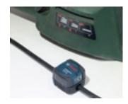
Mit Hilfe von speziellen Befestigungs-Clips können die TrackTags auch direkt am Stromkabel eines Elektrowerkzeugs fixiert werden. (Fotos: Perusteiner)
