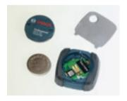
Die wasserdichten Track Tags mit Bluetooth-Sender werden von einer Lithium-Batterie versorgt, die für drei Jahre Betriebszeit reichen soll. Geöffnet wird das Battiefach mit einem Spezial-Schlüssel. Der Tag kann per 2-Komponentenkleber direkt am Werkzeug fixiert werden.
