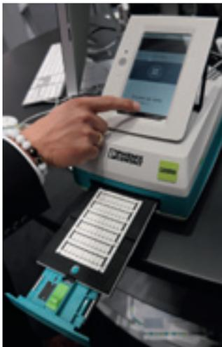
Mobiler Thermomark Prime-Drucker von Phoenix Contact zur industriellen Markierung von Reihenklemmen.
