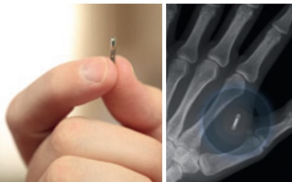
*Dieser Chip kann unter der Haut eingepflanzt werden. Er speichert unter anderem Zugangsdaten zu Rechnern und soll Schlüssel oder Passwörter überflüssig machen. (Quelle: Dangerous things)*
