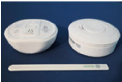
Batterieloser Energiegenerator von Cherry/ZF Friedrichshafen, der in flachen 4-Fach-Wandastern (links) oder Kippschaltern (rechts) gemeinsam mit einer ZigBee-Funktechnik verbaut wird.
