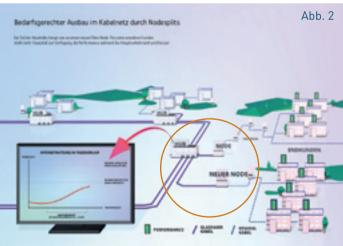
Abb. 2: Ein Teil der Haushalte hängt nun an einem neuen Fibre Node. Für den einzelnen Kunden steht mehr Kapazität zur Verfügung, die Performance während der Hauptverkehrszeit wird besser.
